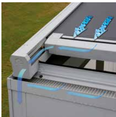
Lagune: La Lagune puede procesar un caudal de lluvia que corresponde a una tormenta con una intensidad de 180 mm/h, durante un máximo de 2 minutos. Este tipo de lluvia se produce de media una vez cada 15 años (Cf. Estadística de lluvia de Bélgica: normativa NBN B 52-011)
