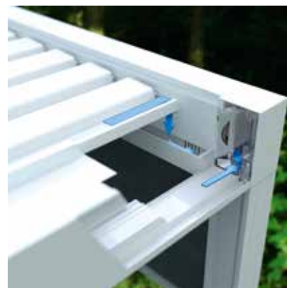
Camargue Line: La Camargue Line puede procesar un caudal de lluvia que corresponde a una tormenta con una intensidad de 180 mm/h, durante un máximo de 2 minutos. Este tipo de lluvia se produce de media una vez cada 15 años (Cf. Estadística de lluvia de Bélgica: normativa NBN B 52-011)
